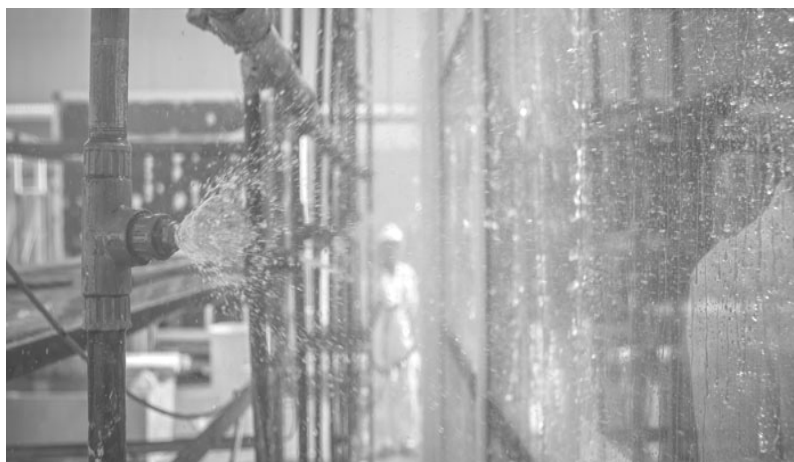
Hình 15.24: Thí nghiệm độ lọt nước (nhìn từ bên ngoài buồng thí nghiệm)
