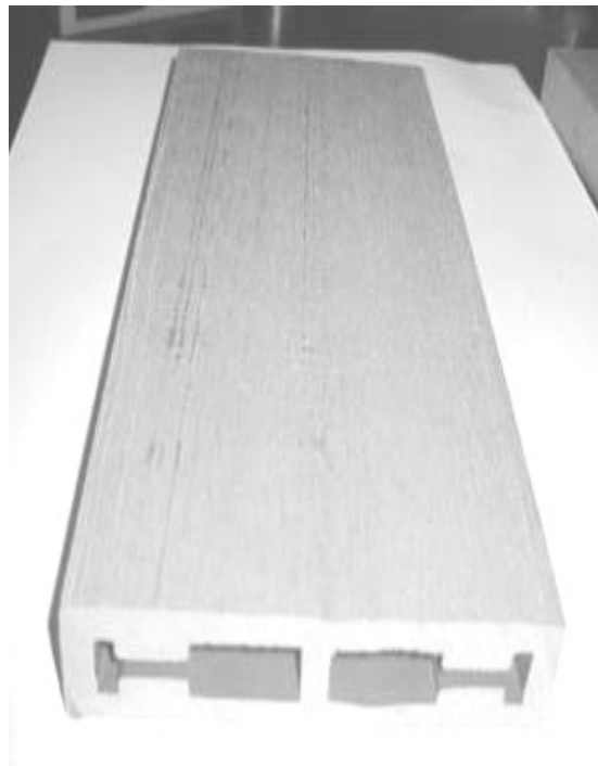
Hình 1.20: Ván sàn composite gỗ-nhựa a) composite gỗ-nhựa PP; b) composite gỗ-nhựa HDPE c) composite gỗ-nhựa PVC
