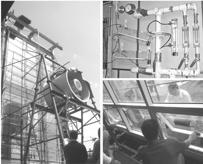
Hình 15.26: Một số hình ảnh thí nghiệm độ lọt nước dưới áp lực động
