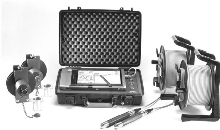
Hình 16.10. Thiết bị siêu âm của hãng Piletest, U.K
