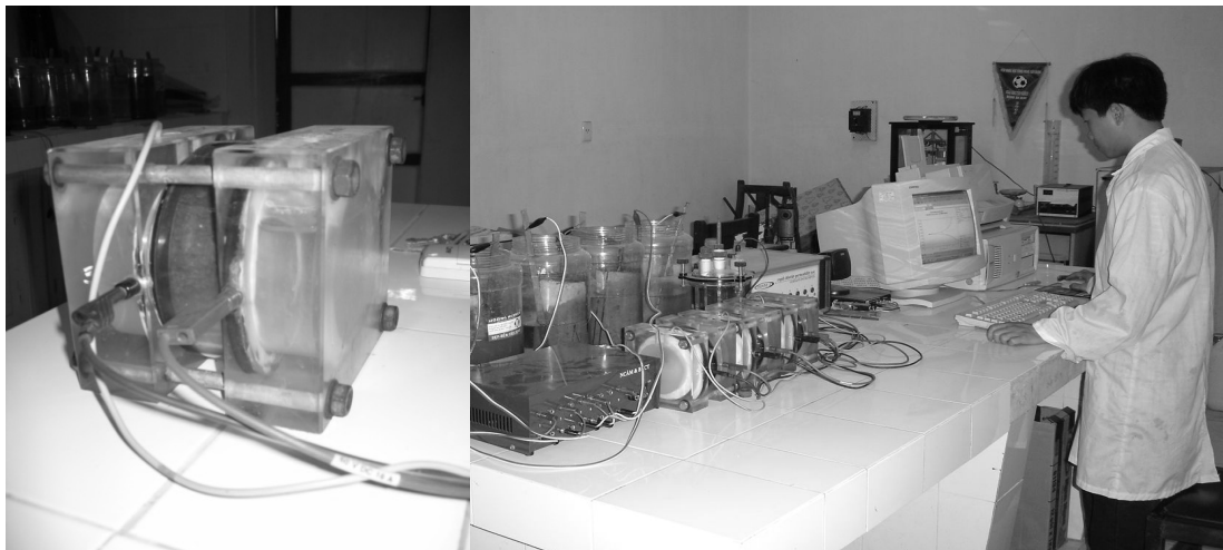
Hình 4.19: Xác định độ thấm ion Clo bằng phương pháp đo điện lượng trong phòng thí nghiệm
